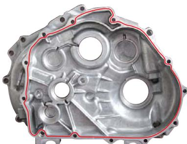
Auftragen von FIPG auf Motorteile
